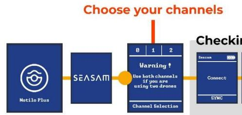
Si durant la plongée, la communication est perdue entre le drone et la télécommande, vous pouvez replacer la télécommande sous-marine sur le drone afin de relancer une synchronisation.
